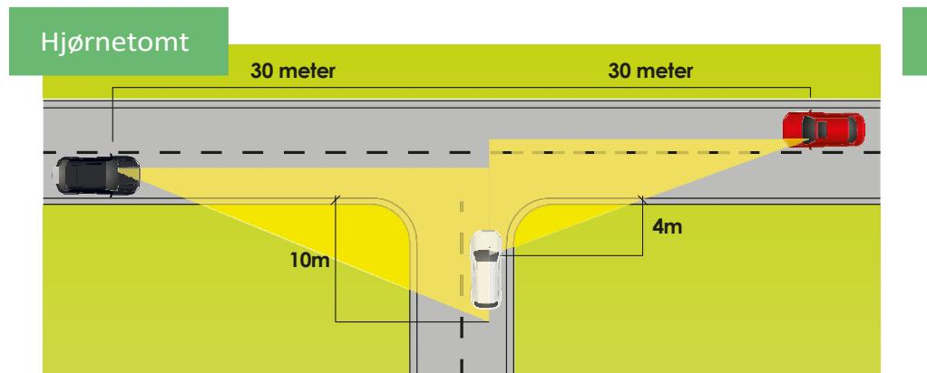
For deg som har hjørnetomt skal det vera fri sikt som vist på teikninga. Du må sørge for at vegetasjon eller gjerde ikkje hindrar fri sikt i vegkrysset. Måla for siktrekanten i vegkryss er avhengig av fartsgrense, trafikkmengd i vegen og utforming av kryss. Måla blir rekna ut med utgangspunkt i veggnormalar.
